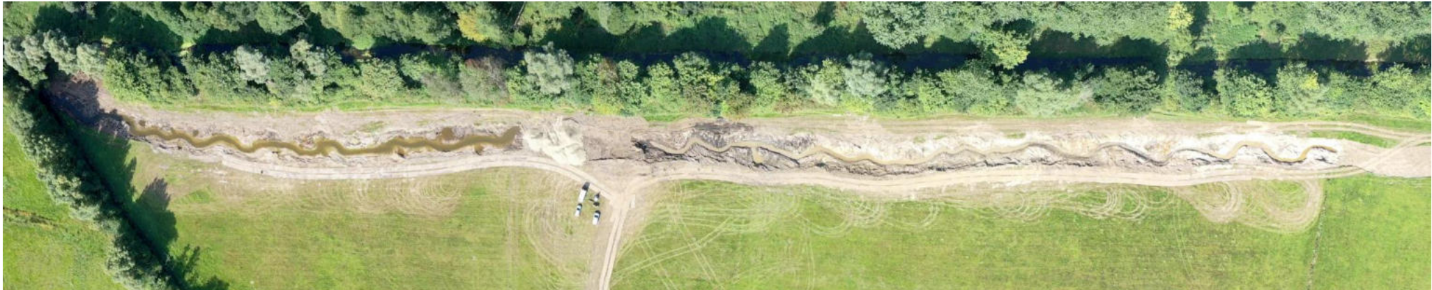
Das neue Flussbett erstreckt sich im Wiesenbereich parallel zum Altlauf (oben im Bild). Innerhalb des gestreckten Verlaufs (hier im Bauzustand) schlängelt sich die Ise deutlich strukturreicher, als es im Altlauf der Fall war.
