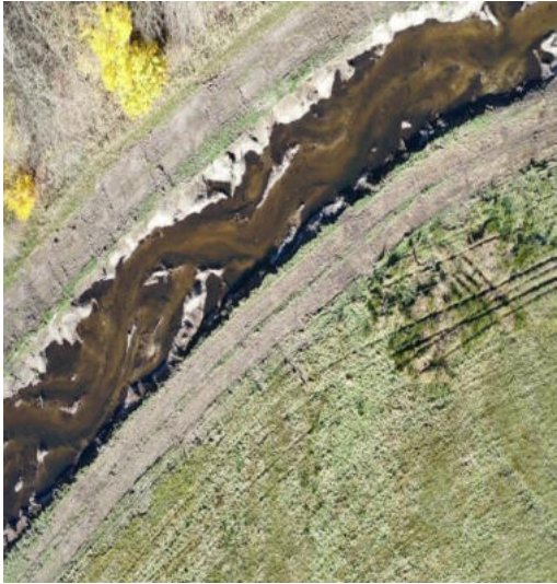
Das neue Flussbett erstreckt sich im Wiesenbereich parallel zum Altlauf (oben im Bild). Innerhalb des gestreckten Verlaufs (hier im Bauzustand) schlängelt sich die Ise deutlich strukturreicher, als es im Altlauf der Fall war.
